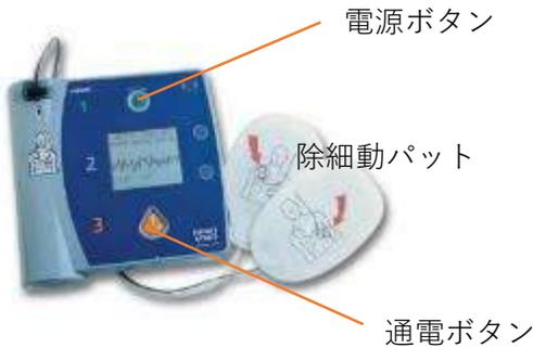
AEDは突然の心停止から命を救うため、痙攣をおこした心臓に電気ショックを与える装置です。操作はガイダンスにより支持され、電気ショックが必要かどうかAEDが判断します。高度な専門知識を必要とせず操作する事ができます。
