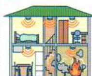
連動型の警報器は、1つの感知器が作動すると全ての感知器が連動して鳴動するため、早く火災に気付くことができます。
